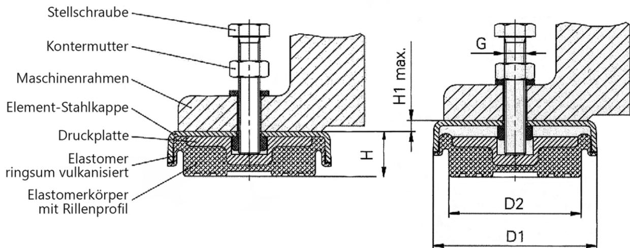
Der einvulkanisierte schwarze Gummidämpfer aus Nitrilkautschuk ( NBR ) ist beständig gegen Mineralöle, Hydrauliköl, Wärmeträgeröl, Pneumatiköl, Getriebe- und Motorenöl, Schmierstoffe, Korrosionsschutz, Schmier- und Filteröle, Öl-Wasser-Emulsionen und brennbare Flüssigkeiten ( Kraftstoffe, Benzin und Flugbenzin, Heizöl, Sonderkraftstoffe, Petroleum ). Temperaturbeständig bis 80°C.
