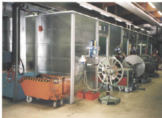
Lärmpegelabsenkung einer Kabine (frequenzabhängig) ca. 30 dB(A)
